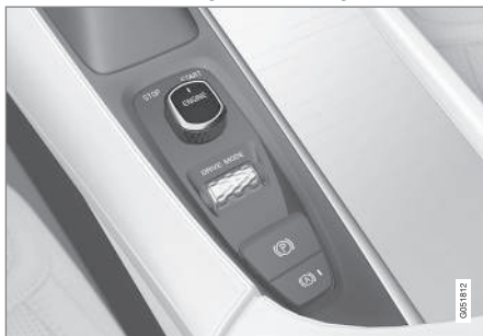
Disco de arranque na consola de túnel.
