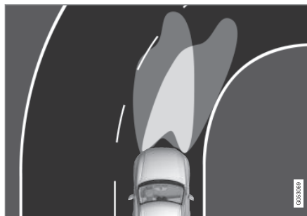
Foco dos faróis com a função desativada (esquerda) e ativada (direita).
