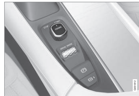
Disco de arranque na consola de túnel.
