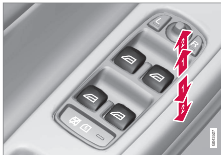
Fonctionnement des vitres électriques
