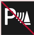
Tenha extremo cuidado ao conduzir para trás quando este símbolo aparece com um atrelado, um suporte de bicicletas ou semelhantes conectado e eletricamente ligado ao automóvel.
