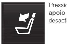
Pressione o botão **Rebat apoio cabeça** para activar/desactivar o rebatimento.
