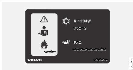
**2** Autocolante sistema A/C para automóveis com refrigerante R1234yf.
