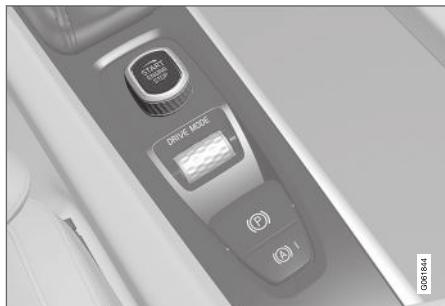
Disco de arranque na consola de túnel.
