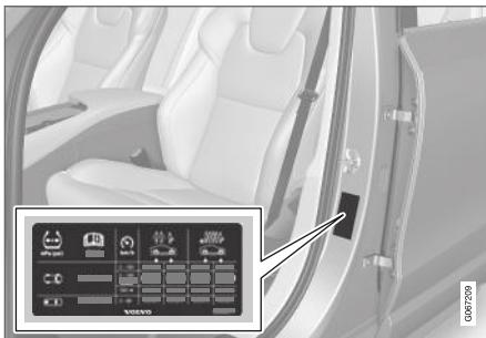
No autocolante encontra a designação do fabricante dos pneus montados no automóvel, assim como os limites de carga e a pressão dos pneus.
