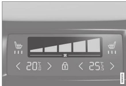
Comando do ventilador no painel de climatização traseiro na consola de túnel.
