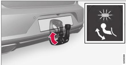
Tranke o engate de reboque inserindo-o de volta para a sua posição retráida onde fica bloqueado.
