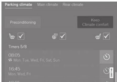
Botão para a preservação do conforto de climatização no separador **Climatização de estacionamento** na vista de climatização.
