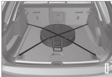
A roda sobresselente é guardada num saco e durante a viagem deve estar presa com duas cintas no chão do compartimento da carga/bagagem. As cintas devem ser tensionadas cruzadas sobre a roda e fixas nos quatro olhais de carga do automóvel.
