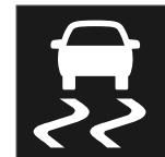
Quando o estabilizador de veículo com reboque actua, o símbolo **ESC** pisca no mostrador do condutor.
