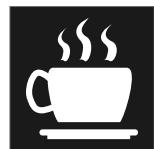
Se o comportamento de condução se tornar significativamente inseguro, o condutor é alertado com este símbolo no mostrador do condutor juntamente com um sinal acústico e a mensagem de texto **Hora de intervalo**.
