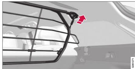
Coloque a as fixações da grelha de proteção nas fixações do tejadilho.
