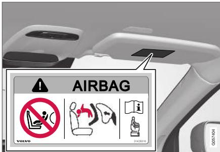
Autocolante na proteção solar do lado do passageiro.
