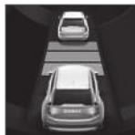
No mostrador do condutor podem ser seleccionados e exibidos diferentes durações de passagem para o veículo da frente através de 1-5 linhas horizontais - quanto maior o número de linhas maior é a duração de passagem ao veículo da frente. Uma linha corresponde a cerca de 1 segundo em relação ao veículo da frente, 5 linhas correspondem a cerca de 3 segundos.
