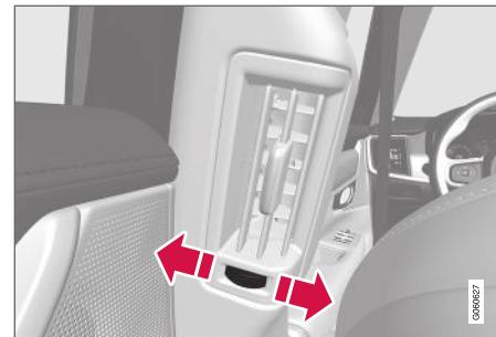
Seletor rotativo da boca de ventilação<sup>2</sup>.
