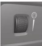
Com o seletor rotativo no tablier, à esquerda do volante, ajusta-se a intensidade da luz da iluminação do mostrador, a iluminação dos comandos a luz ambiente e a iluminação ambiente.\*
