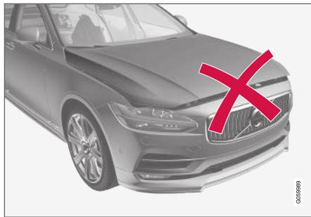
Capot não completamente fechado. A imagem é ilustrativa - os elementos podem variar consoante o modelo de automóvel.
