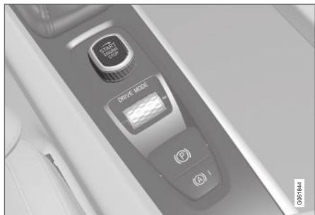
Disco de arranque na consola de túnel.
