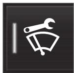
Pressione o botão **Pos serv limpa-p-brisas**. O indicador luminoso no botão acende quando o modo de serviço está ativado. As escovas levantam na activação e mantêm-se em posição erguida. Para desativar o modo de serviço, pressione uma vez em **Pos serv limpa-p-brisas**. O indicador luminoso no botão apaga quando o modo de serviço está desativado.
