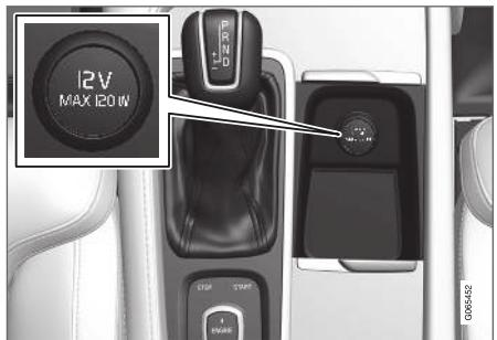
Tomada eléctrica 12 V na consola de túnel, banco dianteiro.
