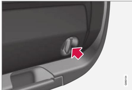
1. Solte o painel no interior da tampa do porta-bagagens rodando os dois manípulos um quarto de volta no sentido contrário ao dos ponteiros do relógio e depois desengatando o painel. Pousa o painel ao lado.
