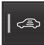
Pressione o botão **Protecção reduzida** na vista de função do mostrador central para desligar os sensores de movimento e inclinação após a trancagem do automóvel.
