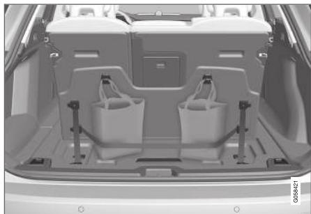
Existem dois sacos para compras e uma cinta elástica<sup>3</sup> na tampa, que faz parte do alçapão, no compartimento de carga. A cinta pode ser montada de quatro formas diferentes.
