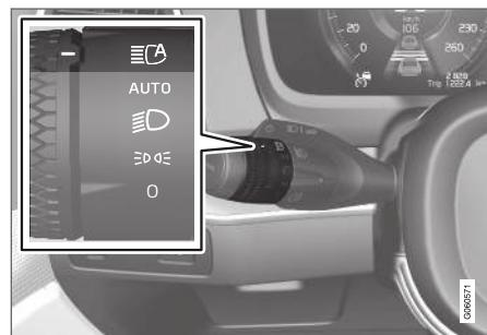
Os máximos automáticos são ativados com o anel rotativo da alavanca do volante na posição **AUTO**.
