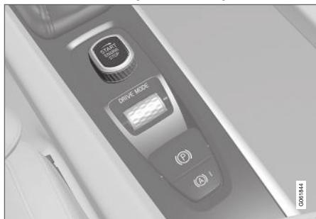
Disco de arranque na consola de túnel.
