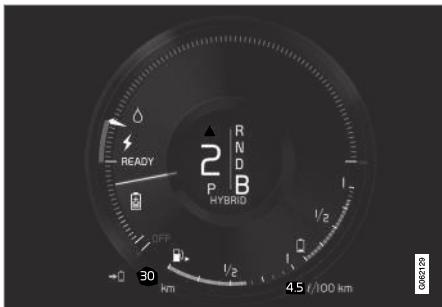
O automóvel gera corrente para a bateria, a bateria é carregada com, por exemplo, ligeira pressão no pedal do travão ou travagem com o motor numa descida.
