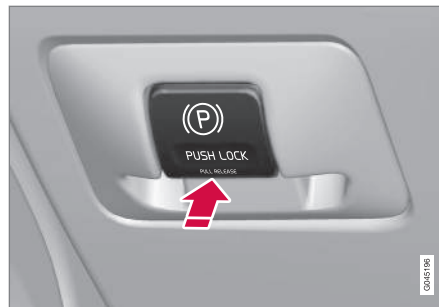
Commande de frein de stationnement - serrage.
