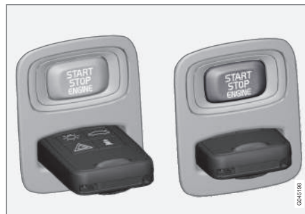
Contacteur d'allumage avec télécommande retirée/insérée.
