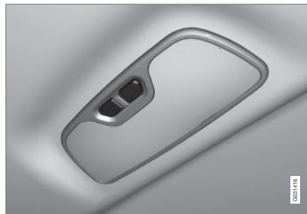
Éclairage de plafonnier arrière dans les voitures avec toit panoramique.
