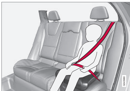
Placement correct, la ceinture doit être placée sur l'épaule.
