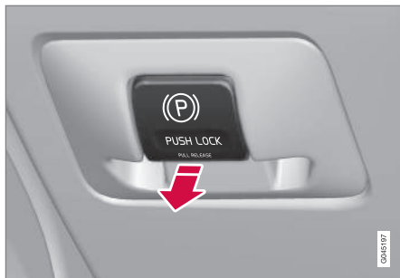
Commande de frein de stationnement - desserrage.
