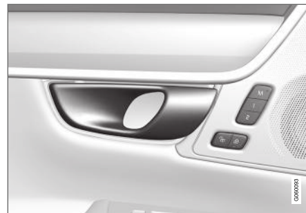
Openingsgreep voor alternatieve ontgrendeling op zijportier 11 .
