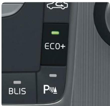
Appuyer sur le bouton **ECO+** de la console centrale pour activer cette fonction développée par Volvo pour vous aider à conduire de manière plus économique et à réduire la consommation de carburant.
