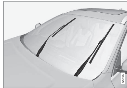
Torkarblad i serviceläge.
