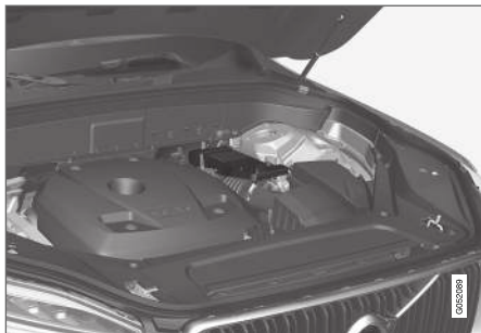
Вспомогательный аккумулятор находится в ящике рядом с пружинной стойкой.
