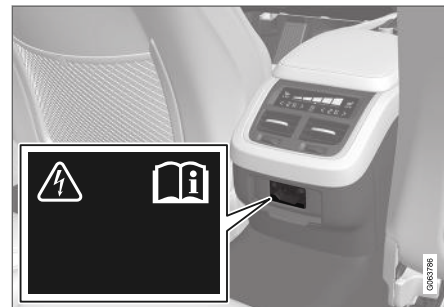
Электрическое гнездо в тоннельной консоли, заднее сиденье.
