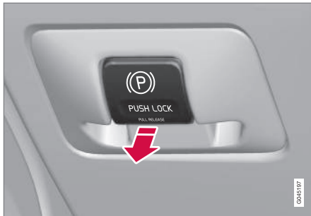
A rögzítőfék kezelőszerve - kiengedés.
