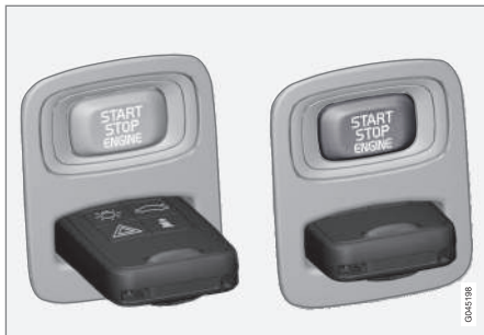
A gyújtáskapcsoló a távvezérlős kulcs eltávolított /behelyezett állapotában.
