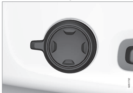
Multifunktionsreglaget, placerad på sidan av sätets sittdel.
