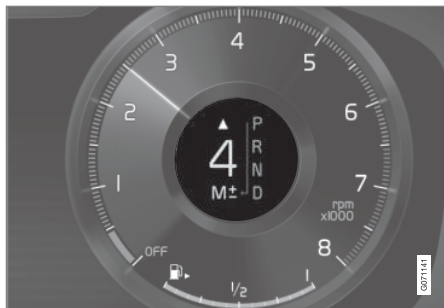
Växlingsindikator i 12-turks förardisplay för stor växelspak*.
