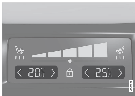
Temperaturreglage på klimatpanelen bak på tunnelkonsolen.
