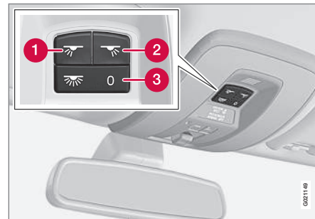
Interrupteurs d'éclairage, éclairage de pavillon avant
