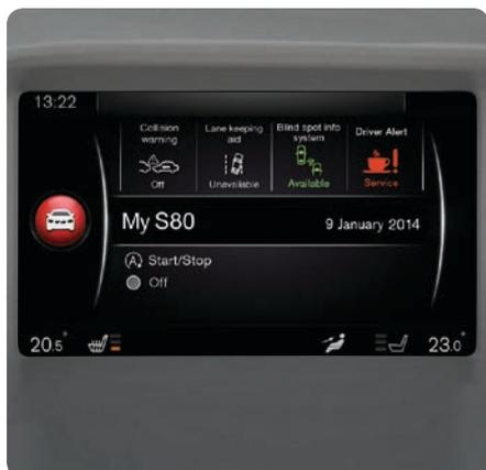
De nombreuses fonctions du véhicule peuvent être contrôlées dans **MY CAR** (ma voiture), comme le réglage de l'horloge, la mémorisation des positions des rétroviseurs extérieurs, les serrures, etc.
