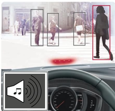
Le système optionnel de détection des piétons et des cyclistes avec freinage automatique complet comporte une fonction qui permet de détecter les piétons et applique les freins pour ralentir ou arrêter le véhicule.
