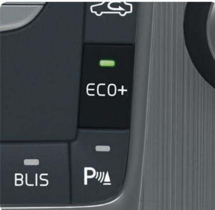
Appuyer sur le bouton **ECO+** de la console centrale pour activer cette fonction développée par Volvo pour vous aider à conduire de manière plus économique et à réduire la consommation de carburant.
