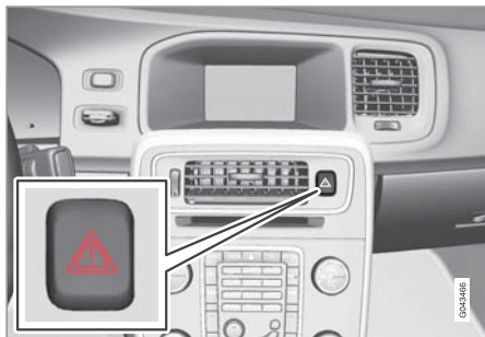
非常点滅灯ボタン
