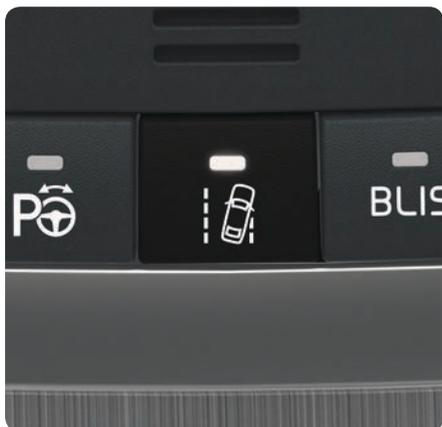
車両がサイドラインを超えそうな場合、LKA がステアリングホイールに軽いトルクを与えて車両を車線内に維持しようとします。車両がサイドラインを超えると、LKA がステアリングホイールを振動させて警告を発します。
