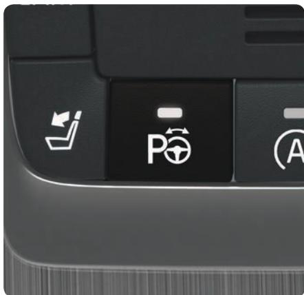
PAP は使用できるスペースを確認し、車両のステアリング操作を行います。運転者の役割は、車両周辺に注意すること、ギヤチェンジすること、速度およびブレーキ/停止を制御することです。
