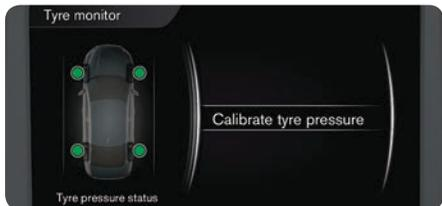
タイヤ交換後またはタイヤ空気圧の変更後には、必ず校正が必要です。(ⓘ) ランプが点灯した場合、タイヤ空気圧の点検とシステムの校正が必要です。以下の手順に従ってください。
