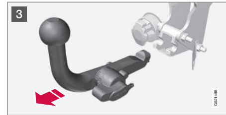
3 Den Verriegelungsknopf vollständig bis zum Anschlag weiterdrehen, herunterdrücken und gleichzeitig die Anhängierzugvorrichtung nach hinten und oben herausziehen.
