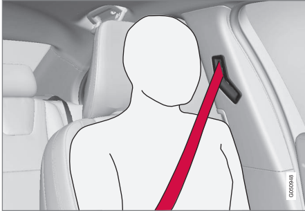
Korrekt angelegter Sicherheitsgurt.
