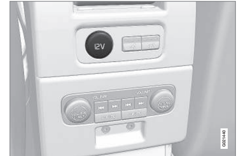
12-V-Steckdose in der Tunnelkonsole, Fond.
