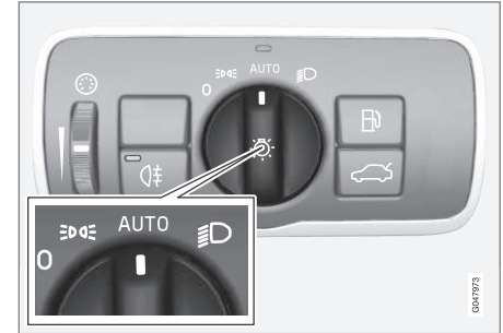
Drehregler des Lichtschalters in Stellung AUTO .
