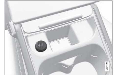
12-V-Steckdose in der Tunnelkonsole, Vordersitz.
