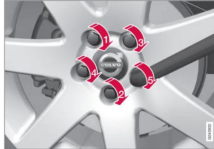
4. Apriete los tornillos de rueda por pares cruzados. Es importante que los tornillos de rueda queden debidamente apretados. Apriete a 140 Nm. Compruebe el par de apriete con una llave dinamométrica.
