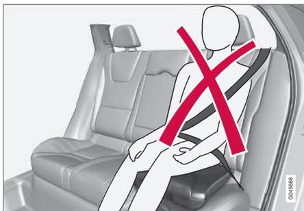
Colocación incorrecta, el cinturón de seguridad no debe ir por debajo del hombro.
