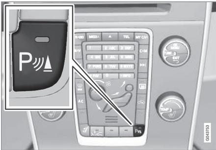
Conexión y desconexión del aparcamiento asistido y el CTA\*.
