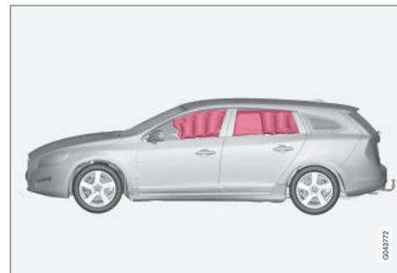
La cortina inflable IC (Inflatable Curtain) forma parte del sistema SIPS (p. 41) y el sistema de airbags (p. 36). Va montado a lo largo de ambos lados del techo interior y contribuye a proteger al conductor y a los pasajeros situados en los asientos exteriores del vehículo. En caso de una colisión de suficiente intensidad, los sensores reaccionan y el airbag de techo lateral se infla.
