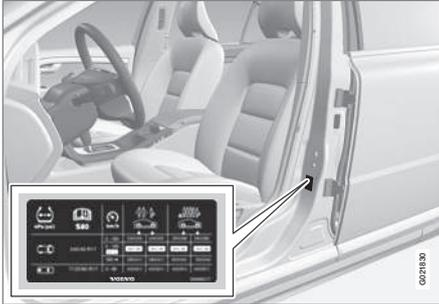
La placa de presión de inflado en el pilar de la puerta del conductor (entre la puerta delantera y la trasera) indica la presión de inflado para las dimensiones de neumáticos recomendadas para el vehículo. Estos datos se indican también en la tabla de presiones de neumáticos, véase Neumáticos - presiones de inflado aprobadas (p. 445).
