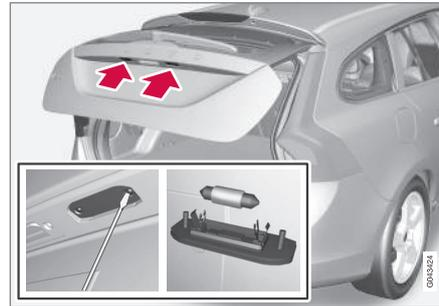
1. Suelte los tornillos con un destornillador.
