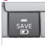
Esta función inicia la carga de la batería híbrida y comprueba que su nivel energético no sea inferior a una capacidad correspondiente a una autonomía eléctrica de aproximadamente 20 km. La idea es poder guardar
