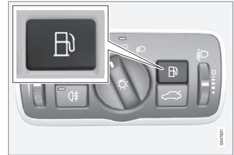
Abra la tapa del depósito con el botón del panel de las luces. La tapa se abre al soltar el botón.
