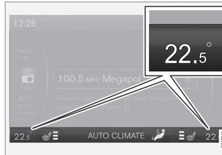
La temperatura en cada lado se muestra en la pantalla de la consola central.
