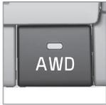
Con este botón de la consola central se activa la tracción integral (AWD – All Wheel Drive), véase Sistema de propulsión - modos de conducción (p. 282). Este modo está previsto principalmente para conducir a baja velocidad en calzadas resbaladizas. La tracción integral tiene también un efecto estabilizador a velocidades más altas.
