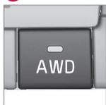
El modo activa la tracción integral, lo que mejora la adhesión a la calzada y el avance del automóvil. El modo está previsto principalmente para conducir a baja velocidad en calzadas resbaladizas, pero la tracción
