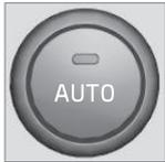
Al seleccionar una o varias funciones manuales, las demás funciones siguen regulándose automáticamente. Cuando se pulsa el botón **AUTO**, se desconectan todos los ajustes manuales. La pantalla muestra
