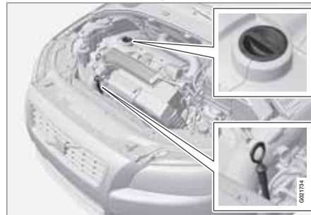
Målepind og påfyldningsrør.
