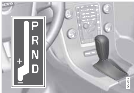
D: Automatiske gearpositioner. +/-: Manuelle gearpositioner.
