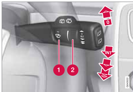
Forrudeviskere og -sprinklere.
