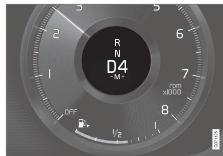
Pantalla del conductor al cambiar de marcha con las levas del volante, palanca de cambios pequeña.
