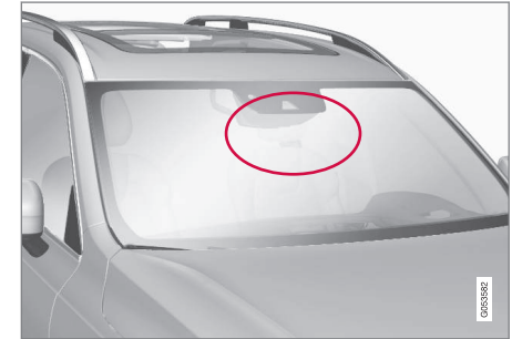
Ubicación de la unidad de radar.
