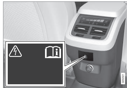
Presa elettrica nel tunnel, seconda fila di sedili.
