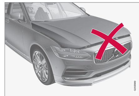
Cofano non completamente chiuso.
