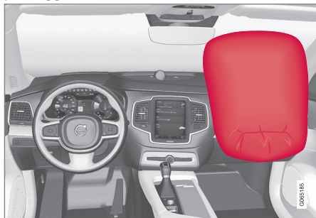
Airbag nel sedile anteriore sul lato passeggero.
