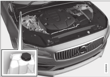
Hűtőfolyadék tágulási tartálya, jobbkormányos autó.
