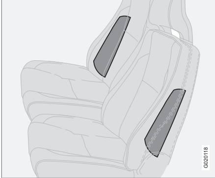
Posizione degli airbag laterali.
