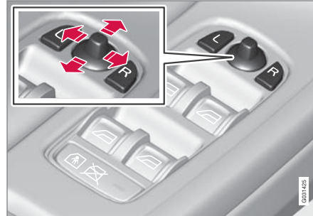
ตัวควบคุมกระຈกมองข้าง
