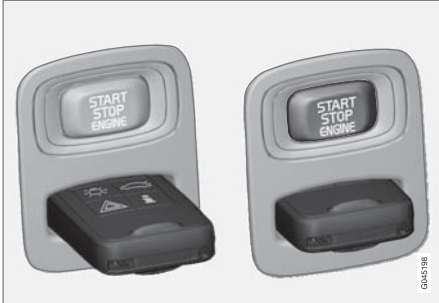
สวิตช์กุญแจที่มี/ไม่มีกุญแจรีโมตคอนโทรลเสียบอยู่ และปุ่ม START/STOP ENGINE
