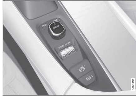
Tünel konsolundaki çalıştırma düğmesi.
