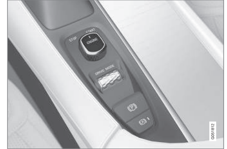
Tünel konsolundaki çalıştırma düğmesi.
