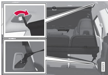
後段安裝位置。
