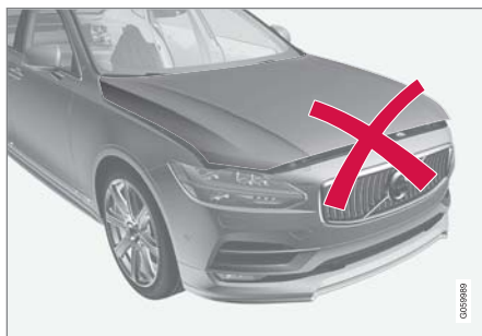
引擎蓋並未完全關閉。
