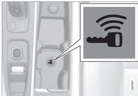
Backup-läsarens placering i tunnelkonsolen.
