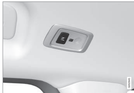
I bil med panoramatak* er det to lampeenheter, en på hver side av taket. 7
