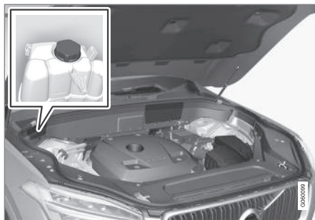
Serbatoio di espansione dell'impianto di raffreddamento
