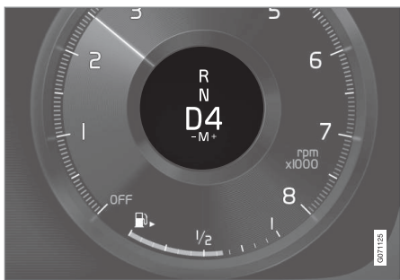
Дисплей водія під час зміни передач підкормовими пелюстками, маленький важіль КПП.
