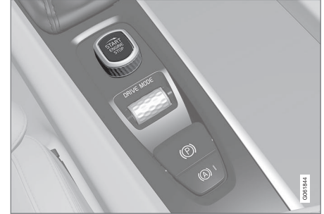
Tünel konsolundaki çalıştırma düğmesi.
