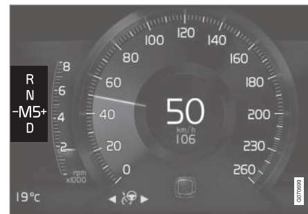
Pokazatelj izbrane prestave za 8-palčni voznikov zaslon za majhno prestavno ročico.
