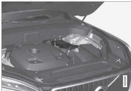
12 V pomožni akumulator je nameščen v ohišju ob vzmetni nogi.
