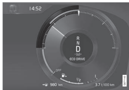
Merilnik Eco na 12-palčnem voznikovem zaslonu*.
