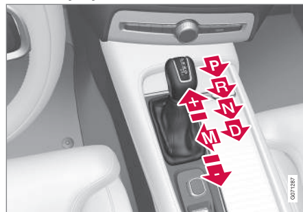
Pregled velike prestavne ročice in položajev menjalnika.
