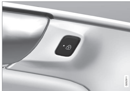
Låseknapp med indikatorlampe i bakdør.
