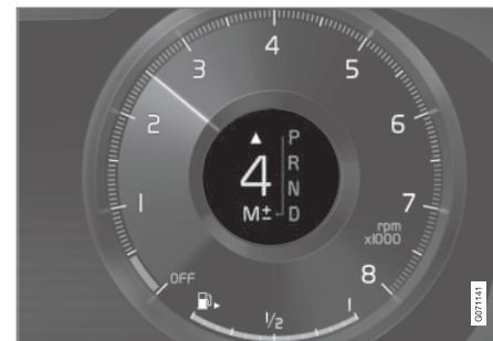
Schakelindicator op 12 inch bestuurdersdisplay voor de grote schakelhendel*.
