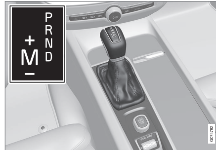
Panoramica della leva selettoria grande e schema di cambio sul display del conducente.
