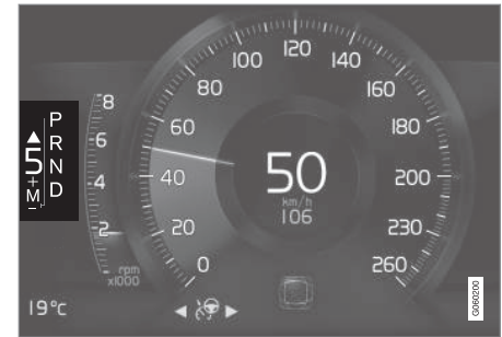
Indicatore cambio di marcia sul display del conducente da 8" per la leva selettoria grande.
