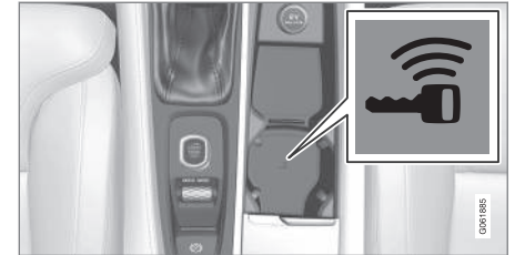
Posizione del lettore di riserva nella consolle del tunnel.
