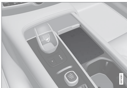
Caricabatterie senza fili per telefono nel tunnel.
