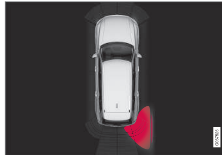
Icona Cross Traffic Alert accesa nella grafica Assistenza al parcheggio dello schermo.
