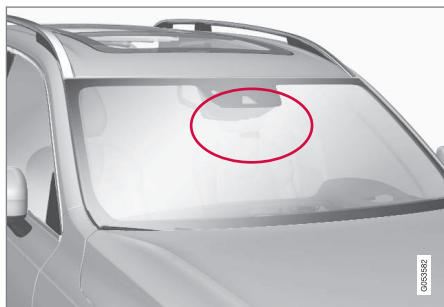
Emplacement de l'unité radar
