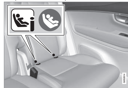
L'emplacement des points de fixation ISOFIX est indiqué par des symboles 2 sur la garniture du dossier.
