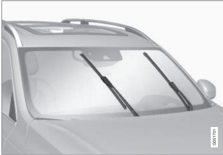
Balais d'essuie-glace en position d'entretien.
