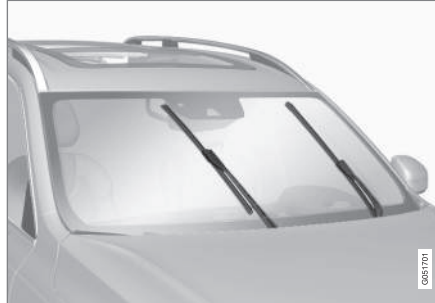
Balais d'essuie-glaces en position d'entretien.
