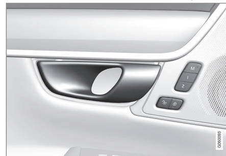
Méthode alternative de déverrouillage en utilisant la poignée d'ouverture de porte latérale 11 .
