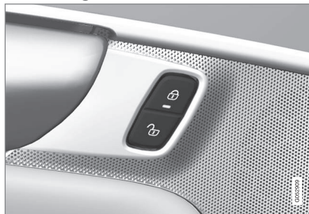
Bouton avec lampe indicatrice de verrouillage et déverrouillage de la porte avant.
