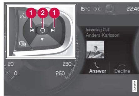
Exemples de messages du tableau de bord 5 et clavier placé à droite du volant de direction. L'illustration est générique - les détails peuvent varier en fonction du modèle de véhicule.
