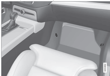
Kiinnityskohtien sijainti etuistuimessa.
