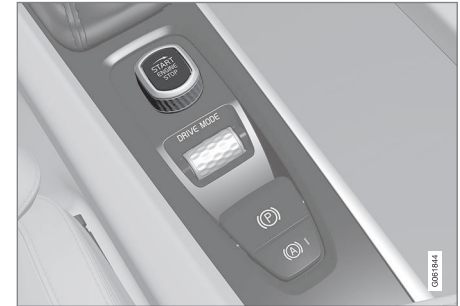
Käynnistyskytkin tunnelikonso- lissa.
