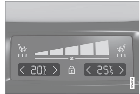
Tunnelkonsooli tagaosa kliimapaneeil olev temperatuuri regulaator.
