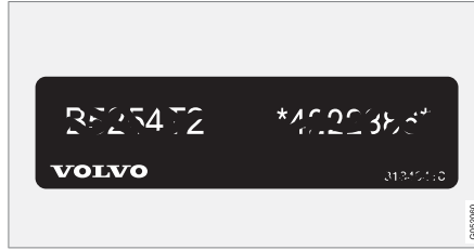
4 ملصق رمز المحرك والرقم المسلسل للمحرك. هناك بعض نماذج المحركات التي لا تحمل أي ملصق. في مثل تلك الحالات، يمكن قراءة رمز المحرك المحفور مباشرة على المحرك.
