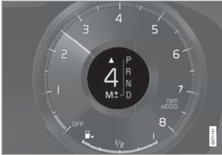
مؤشر تشغيل التروس في شاشة السائق قياس ١٢ بوصة، في حالة ذراع تغيير التروس الكبير.*
