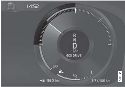
مقياس Eco في شاشة السائق قياس ١٢ بوصة*.
