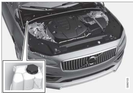
冷卻液膨脹水箱，左駕車
