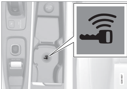
Backup-läsarens placering i tunnelkonsolen.
