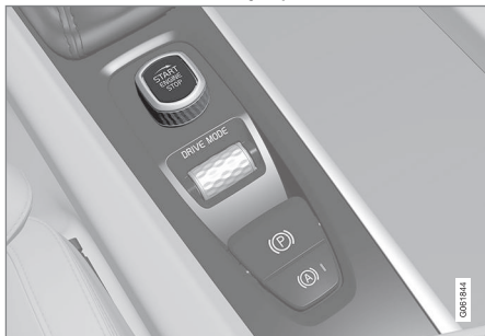
Pokrętko rozruchu na konsoli między fotelami.
