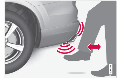
Movimento fluido entro il campo di attivazione del sensore.
