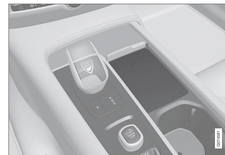
Caricabatterie senza fili per telefono nel tunnel.
