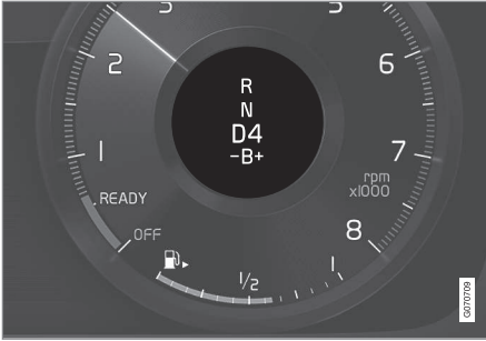
A járművezetői kijelző, amikor a kormánykerék fűlével vált sebességfokozatot.
