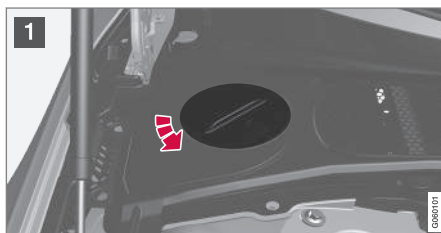
Hűtőfolyadék tágulási tartálya, balkormányos autó
