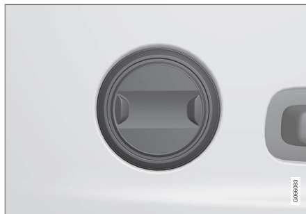
Kezelőszerv kétirányú deréktámaszszal* rendelkező autókban.
