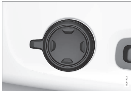
Többfunkciós kezelőszerv négyirányú deréktámaszszal* rendelkező autókban.
