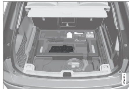
Az indítóakkumulátor a csomagterben helyezkedik el.
