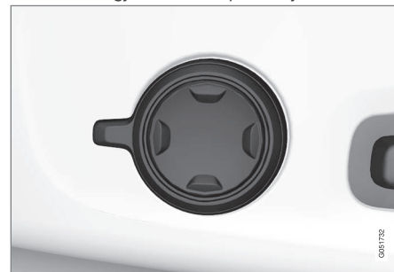
Többfunkciós kezelőszerv, az ülés ülőrésének oldalán.
