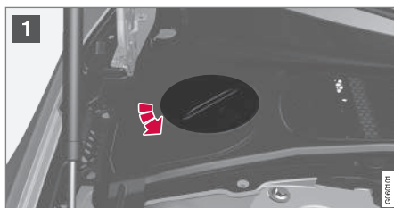
Jäähdytysjärjestelmän paisuntasäiliö, vasemmalta ohjattava auto
