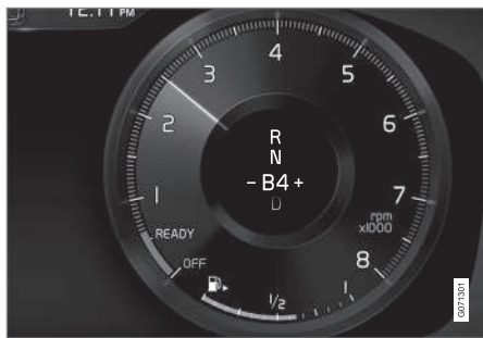
Kuljettajan näyttö vaihdettaessa ohjauspyörävalitsimilla käsinvaihtoasennossa.
