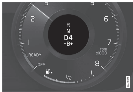
Kuljettajan näyttö vaihdettaessa ohjauspyörävalitsimilla.
