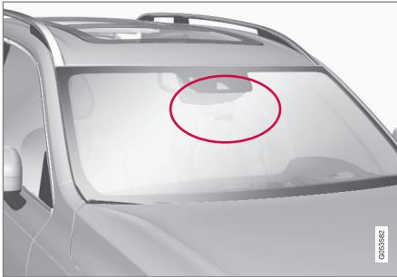
Ubicación de la unidad de radar
