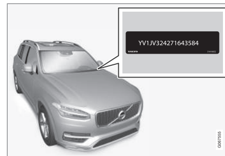
Die VIN ist in sämtlichen Modellen ähnlich platziert.
