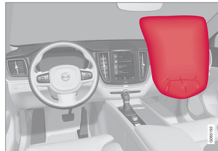
Airbag til forsædet i passagersiden
