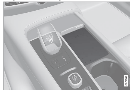
Trådløs telefonoplader i tunnelkonsollen.
