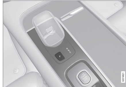
Prezentarea selectorului de viteze și poziția P pentru selectorul de viteze mic.
