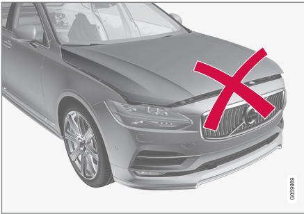
Niedomknięta pokrywa silnika.
