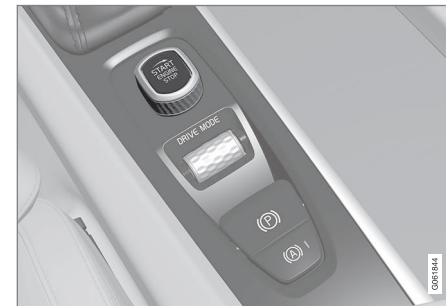
De startknop op de tunnelconsole.
