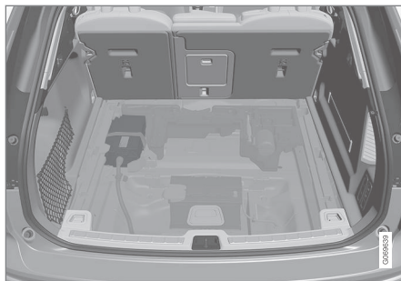
Als de auto in plaats daarvan met een hulpaccu van 48 V is uitgerust, dan zit deze links in de laadruimte. De hulpaccu van 48 V mag uitsluitend door een erkende werkplaats worden behandeld.
