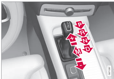
Overzicht grote schakelhendel en schakelstanden.
